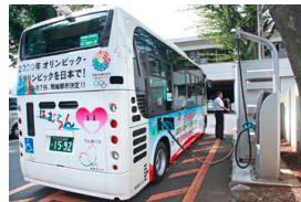
羽村市 「でんきバスはむらん」 ※専用の急速充電器で充電中
