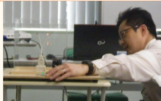
半断線によるショートの実験
