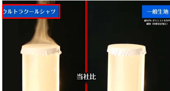
シャツの生地片に蒸気を当てた実験 (当社HPより)
